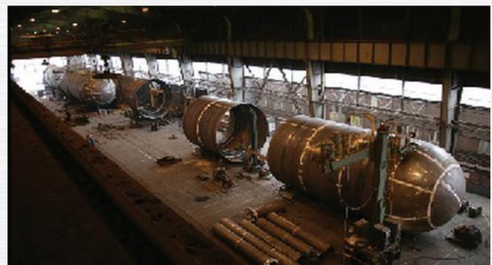
Réalisation et expédition d'appareils de stockage sous talus
